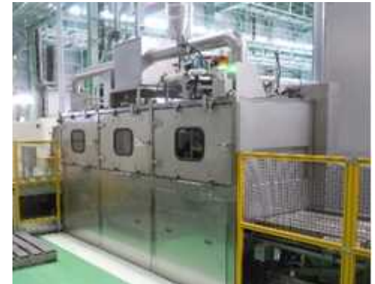
環境負荷を低減できる設備 (導入事例：薬剤を使用しない部品洗浄装置)
