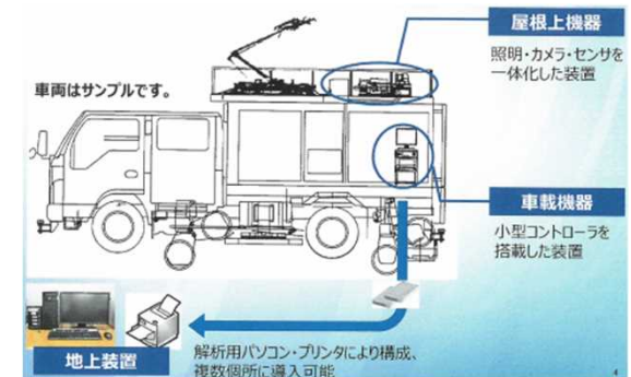
点検車両導入による検査業務効率化 軌陸車型架線モニタリングシステム (イメージ)
